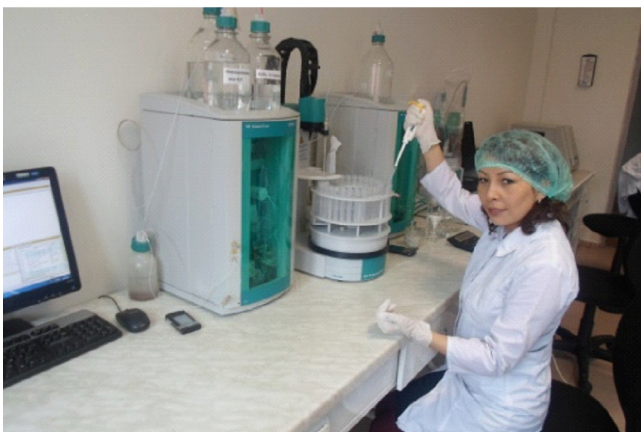
Определение содержания растворенных анионов и катионов методом жидкостной ионнообменной хроматографии
