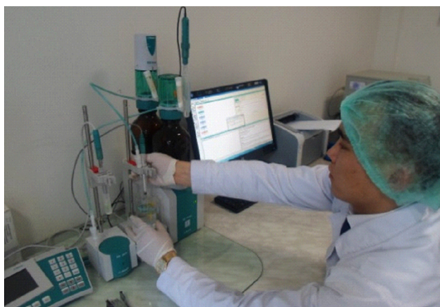
Автоматический титратор модели Titrandо фирмы Metrohm предназначен для измерения концентрации ионов
