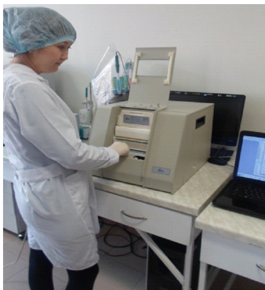
Измерение массовых концентрации анионов и катионов с применением системы капиллярного электрофореза «Капель-105М»
