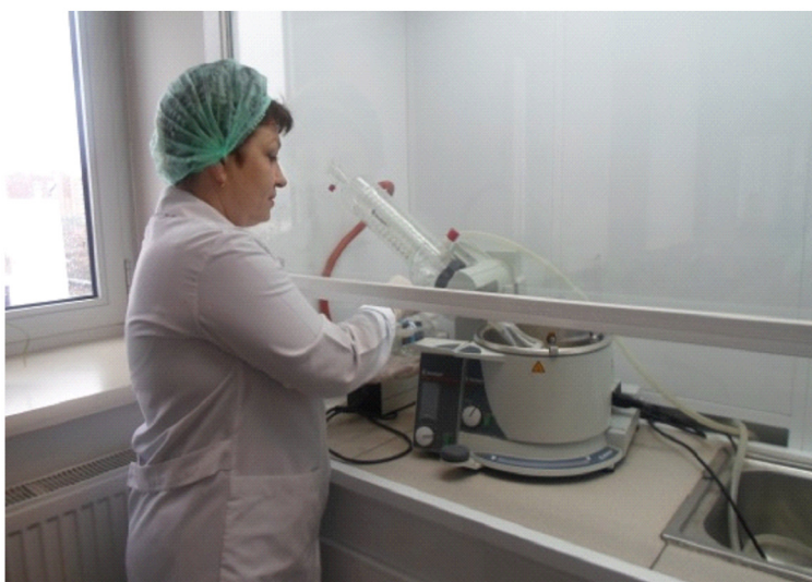
Роторный испаритель Heidolph предназначен для перегонки и очистки веществ
